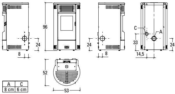
Version avec sortie fumées supérieur coaxial en option
